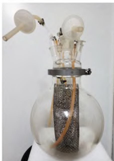
Ryc. 5. 10- litrowy bioreaktor zraszany do hodowli korzeni włośnikowatych
